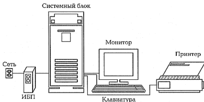
Рис. 1.1. Состав основных блоков ПК [1]
