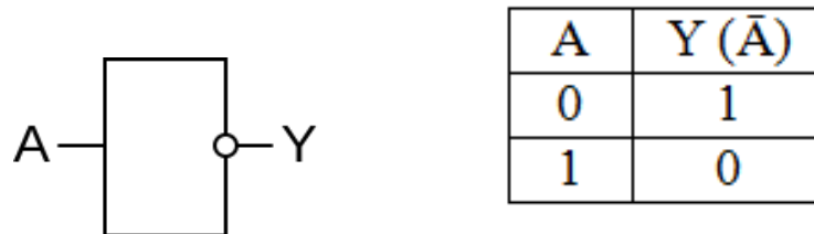
Рис. 4.7. Логический элемент «НЕ» и его таблица истинности
