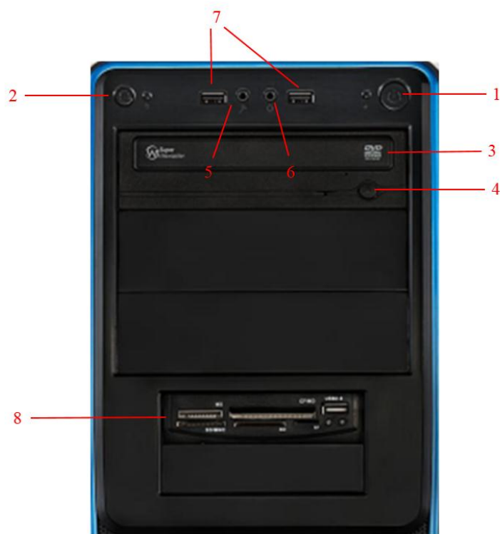
Рис. 1.4. Порты и разъемы передней панели системного блока: 1 – кнопка «Пуск»; 2 – кнопка «Перезагрузка»; 3 – DVD-привод; 4 – кнопка открытия DVD-привода; 5 – разъем для микрофона; 6 – разъем для наушников; 7 – USB порты; 8 – блок картридеров (cardreader)
